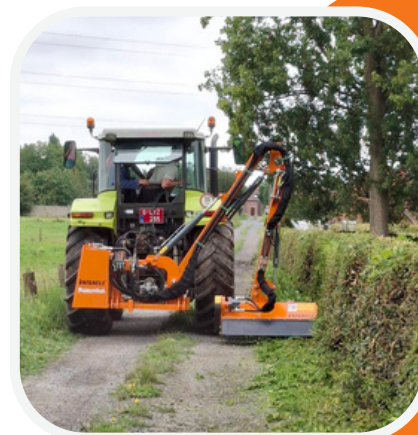
Hydraulische beveiliging bij obstakels
