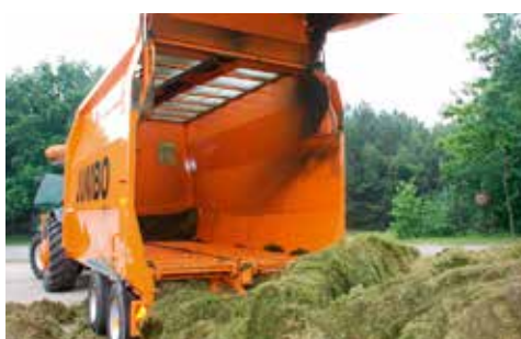
Leegmaken van de zuigwagen geschiedt door middel van een vloerketting systeem.
