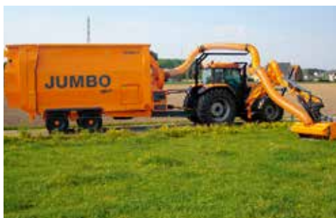
Maaien met afzuiging; veiligheid: minder opwaaien van maaisel na passage en creatie van meer biodiversiteit door bermvershraling.
