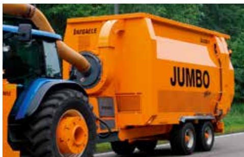
Speciaal ontwikkelde zuigwagen “Jumbo Max” — 31m³ laadvermogen.
